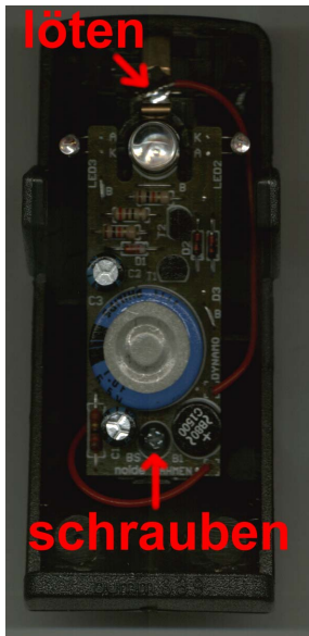
Abb.9: Einbau der Platine: Leitung RAHMEN unter Bolzenkopf klemmen, Platine oben unter Kupferlasche einhängen und unten verschrauben, Leitung DYNAMO an Lasche anlöten.
