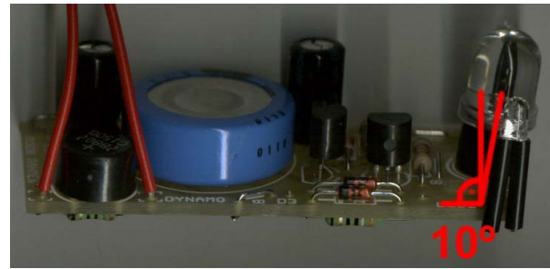
Abb.5: Seitenansicht der bestückten Platine: Die Neigung der LEDs ist zu beachten!
