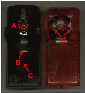
Abb.8: Vorbereitung des geöffneten Rücklichtgehäuses für den Platineinbau: Der untere Teil der Birnchenfassung „A“ ist zu entfernen.
